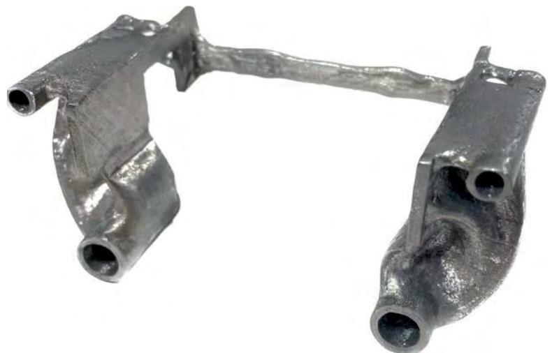
Ilustración 2: Portapinzas diseñado mediante optimización topológica y fabricado en la impresora Alba 300.
