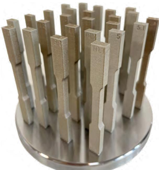
Ilustración 1: Probetas impresas mediante SLM
