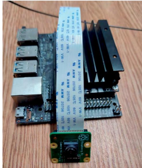
Jetson Nano + Cámara de ejemplo (cámara RaspberryPi)
