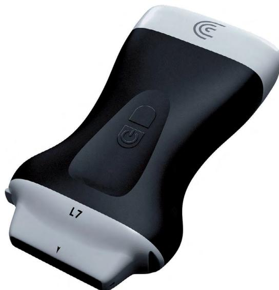
Figura 1. Ecógrafo de mano Clarius L7 HD utilizado en ECOFRAIL.
