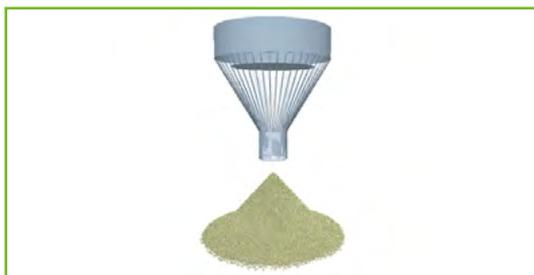
Simulación del experimento de ángulo de reposo en software DEM
